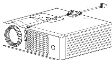
**Facile à installer.** Le système de contrôle Pixie+ prend la forme d'un boîtier mural en saillie ou encastrable avec façade. Un câble à 3 fils relie le PixiePlus et le module de contrôle IR et RS232. Ce câble transporte l'alimentation et les signaux à la connexion côté vidéoprojecteur RS232 et/ou IR. Un bloc d'alimentation est fourni et à connecter côté projecteur. Plusieurs émetteurs IR peuvent être ajoutés pour contrôler plusieurs appareils (options).
