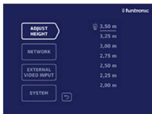
Option **AJUSTEMENT DE LA HAUTEUR** permet à l'utilisateur de sélectionner **la hauteur entre le sol et l'appareil (distance entre le sol et la face avant)**. Confirmer la sélection avec le bouton **OK**. **Ce réglage ne doit être fait que** à l'installation ou lors du déplacement de l'appareil.
