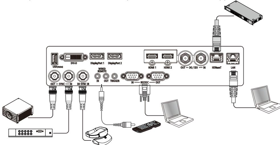
**HDBaseT / LAN (contrôle réseau) :** Le projecteur prend en charge le contrôle par réseau. Le LAN et HDBaseT partagent le même port. Si seul le contrôle par réseau est utilisé, vous pouvez raccorder le LAN sur le projecteur à un PC ou via le réseau local. Reportez-vous au manuel de contrôle à distance pour des informations détaillées.
