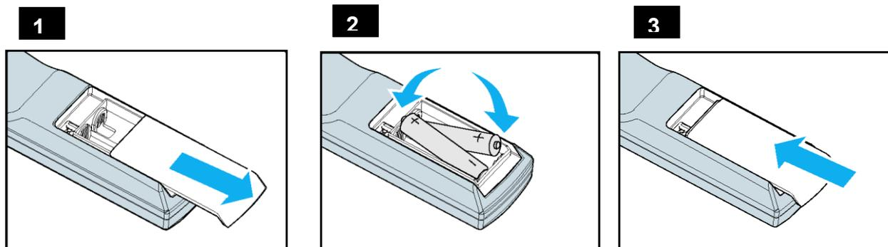
1. Ouvrez le couvercle du compartiment à pile en le glissant dans le sens de la flèche.
