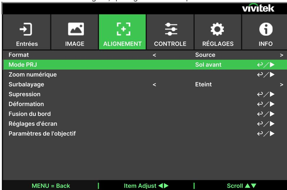
Appuyez sur le bouton ENTRÉE ou ▶ pour accéder au sous-menu et utilisez le bouton ▲▼ pour sélectionner un mode de projection afin de retourner l'image projetée selon le sens d'installation ou le sens de visualisation. Les options de sélection sont décrites ci-dessous.
