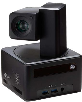
Système de communication unifiée complet comprenant une caméra PTZ USB Compass avec rappel de prépositions, un PC basé sur la technologie Intel® Core™ I5 avec technologie vPro™, un système audio blue tooth Harman/kardon et un ensemble clavier souris sans fil.
